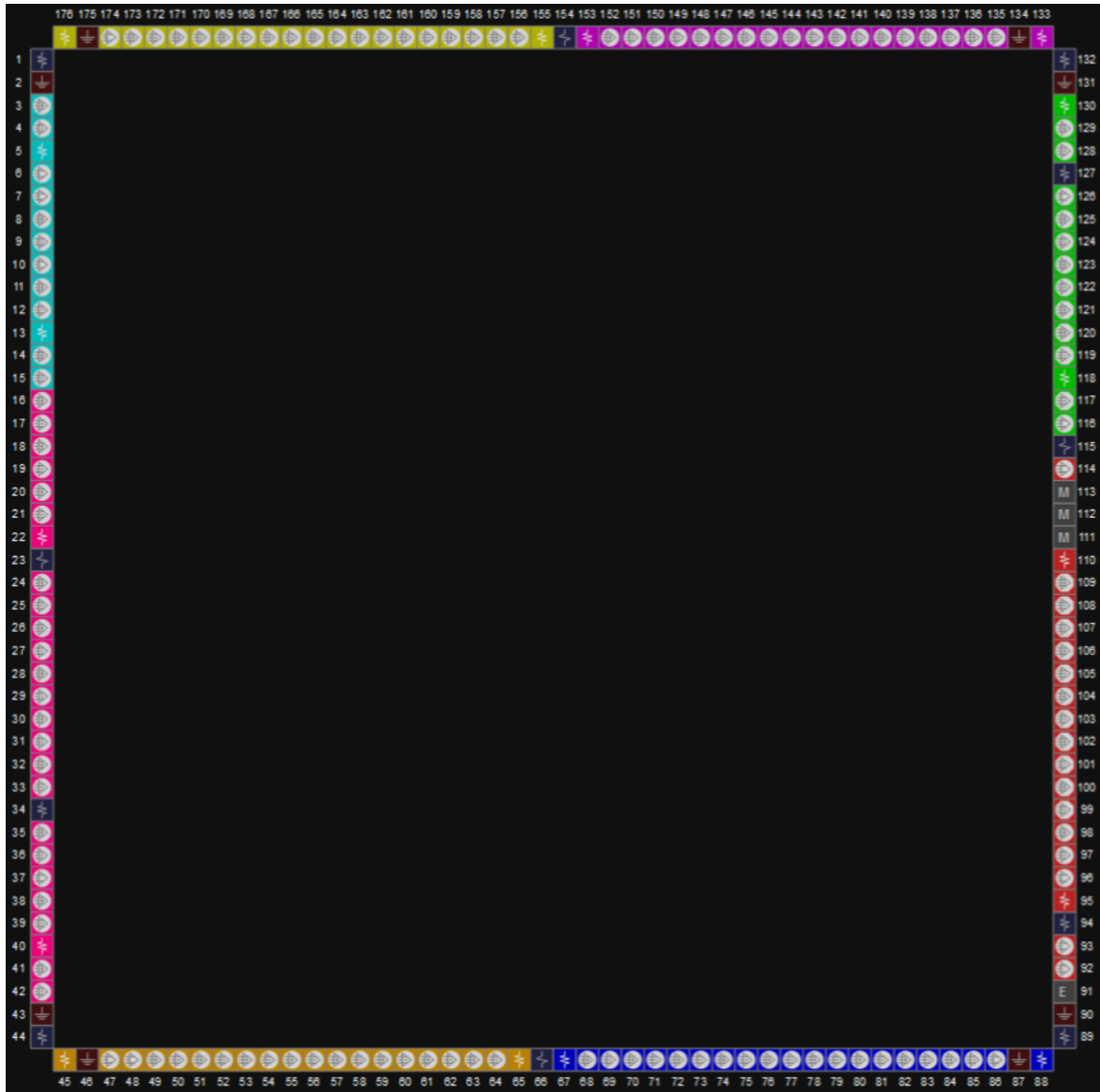
图 3-3 GW2AR-18 器件 LQ176 封装管脚分布示意图
