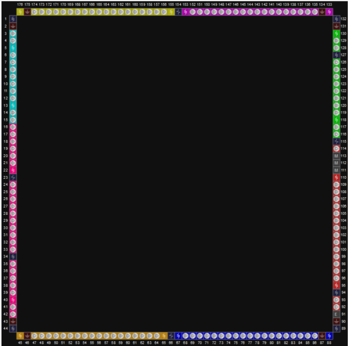
图 3-3 GW2AR-18 器件 LQ176 封装管脚分布示意图
