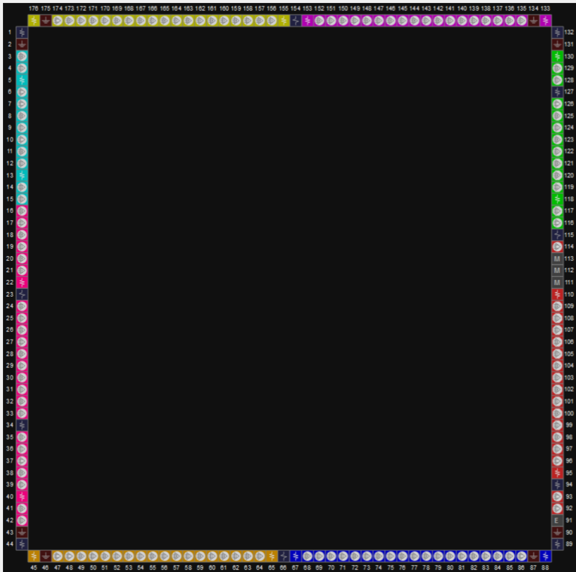
图 3-3 GW2AR-18 器件 LQ176 封装管脚分布示意图
