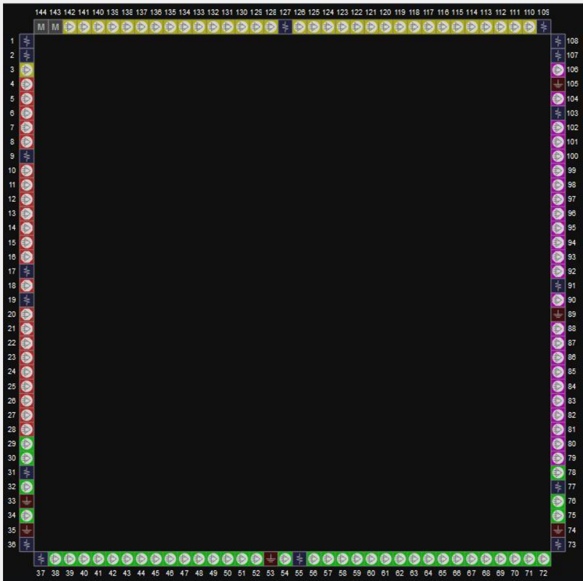
图 3-2 GW1NR-9 器件 LQ144 封装管脚分布示意图（顶视图）
